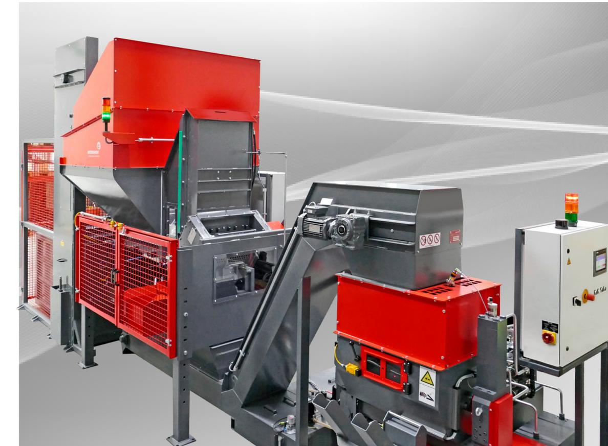
Die Entwicklung der innovativen M600/1-600-3S Zerkleinerungsmaschine mit Schnecken-zuführung und integriertem Störstoffhandling basiert auf langjähriger praktischer Erfahrung. Voluminöse Spänegewölle sind das Resultat der teilweise sehr großen Zuführungsmengen. Die gewonnenen Erkenntnisse aus Zerkleinerung problematischer Massivteilen trägt unserer Professionalität bei.
